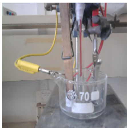
Figure II.5 : Cellule électrochimique composées de trois électrodes.
