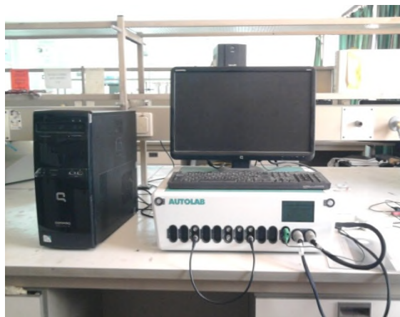
Figure II.11 : Représentation de l'appareillage électrochimique utilisé.
