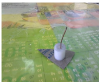
Figure II.6 : Electrode à pâte de carbone graphite modifiée et non modifiée.
