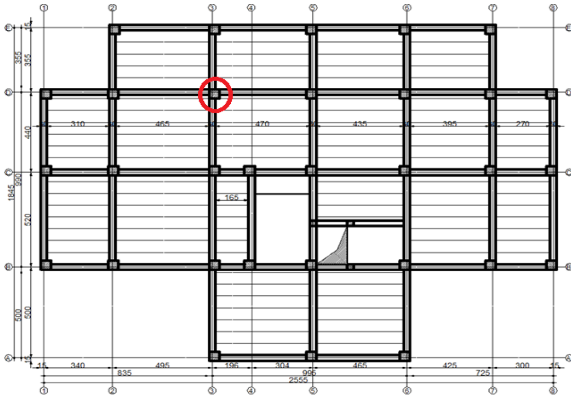
Figure II.11. Emplacement du poteau le plus sollicité D 3
