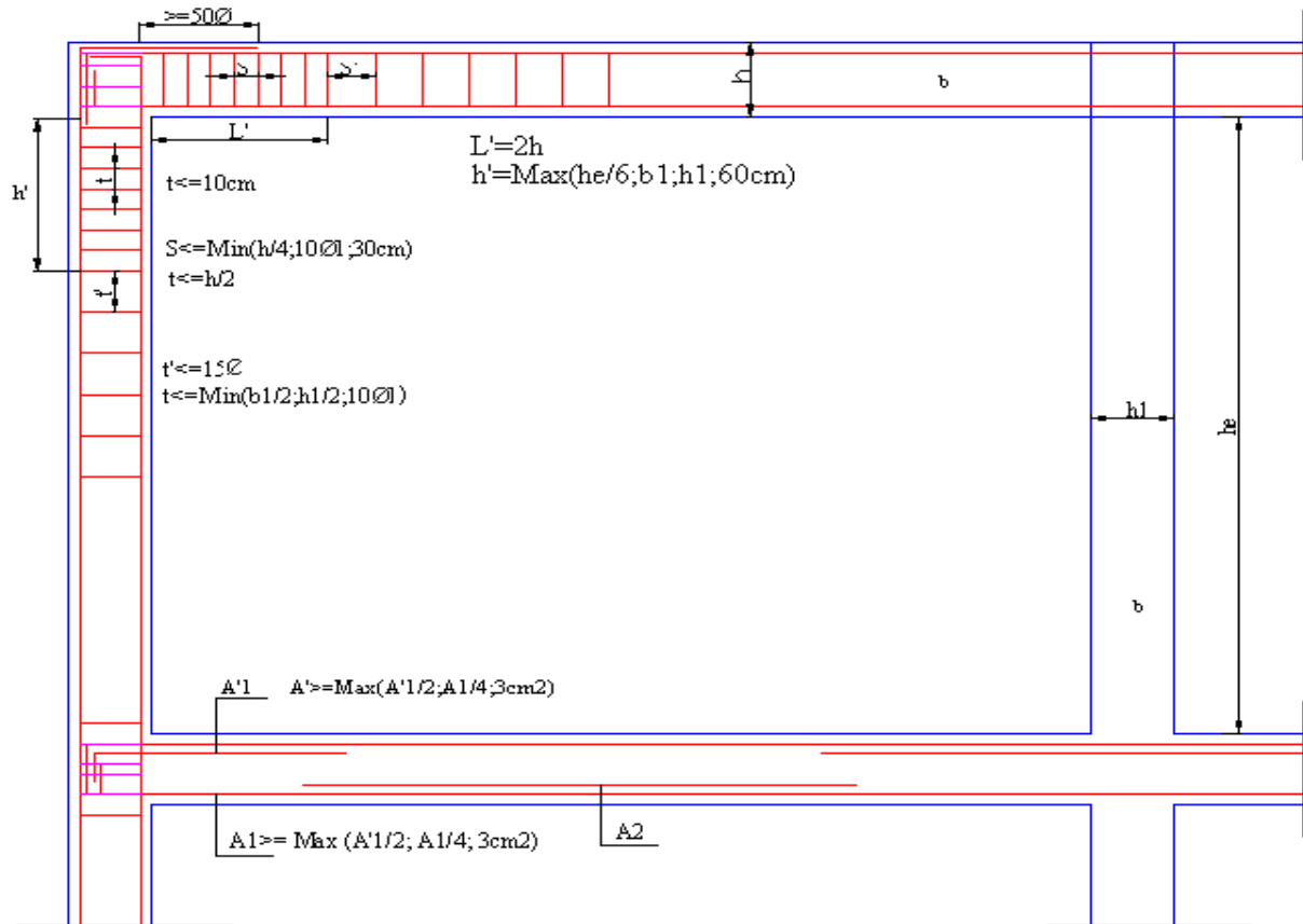
Figure V.1. Dispositions constructives des portiques
