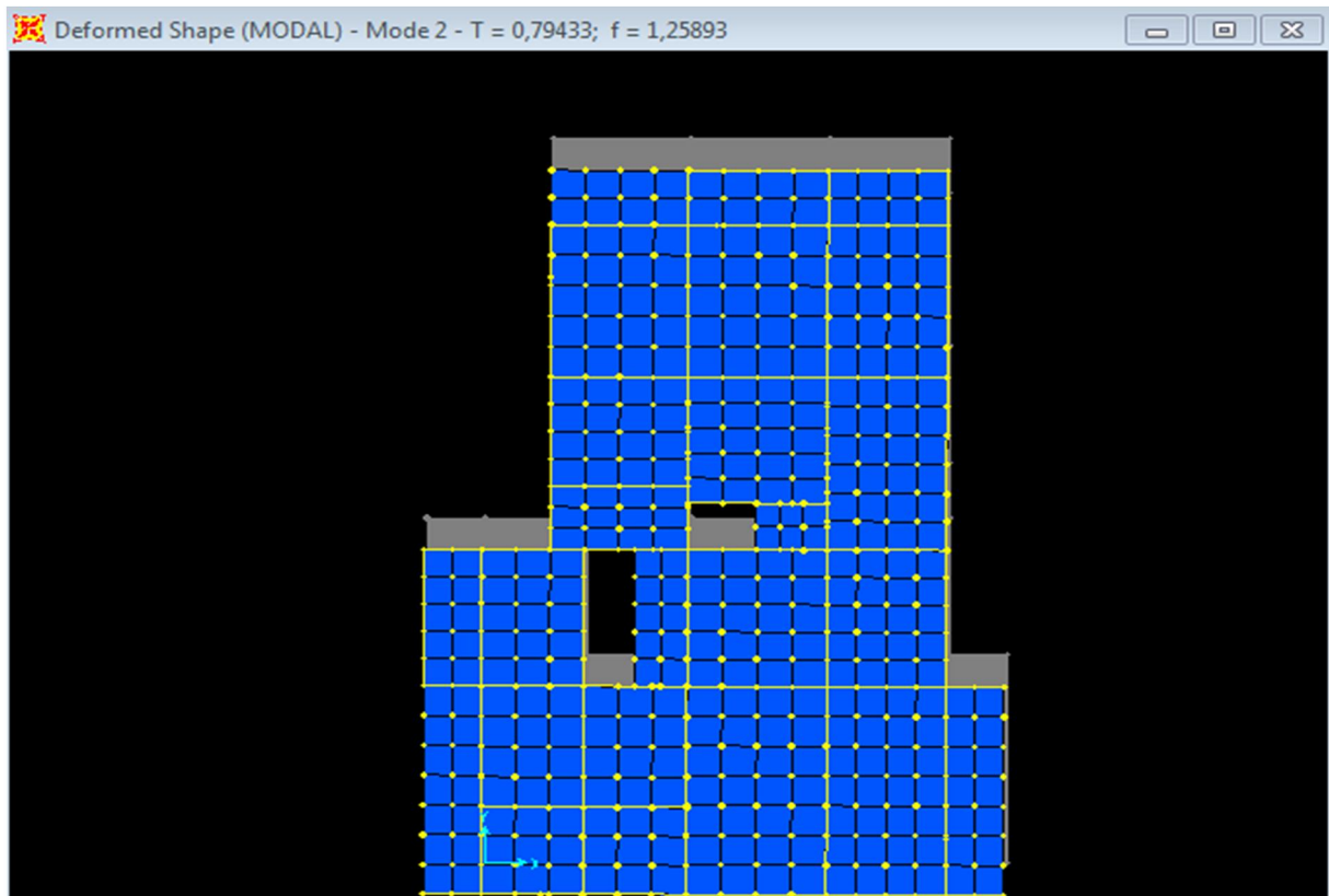
Figure IV-4 : 2 ème Mode de vibration (T=0.794s translation suivant Y).
