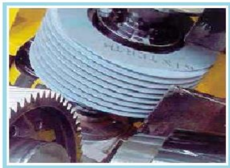
Figure II.9 : Rectification des dentures
