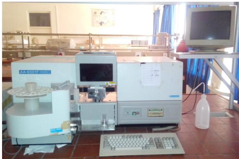
Figure II-15. Spectrophotomètre d'absorption atomique SHIMADZU AA-6501F.
