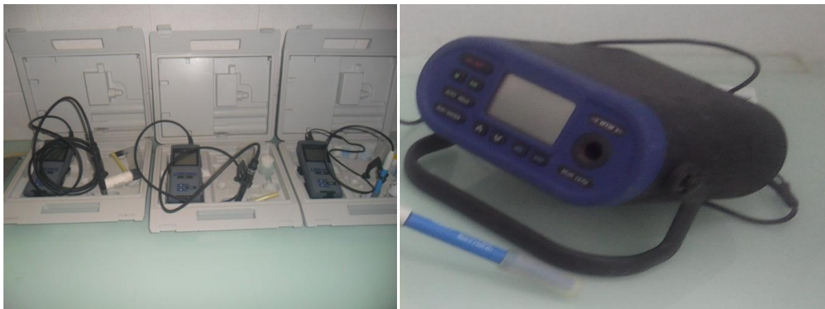
Figure II-1. Equipements portatifs de mesure de paramètres physico-chimiques.
