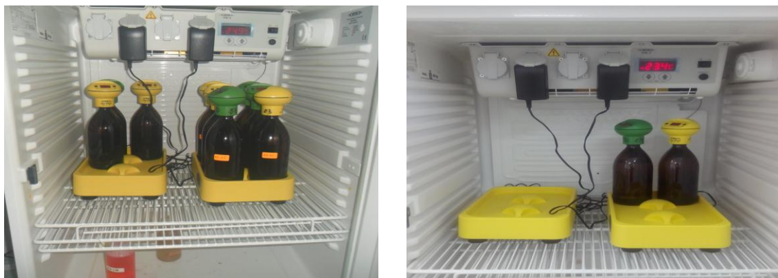
Figure II-4. Dispositif de mesure de la DBO 5 .
