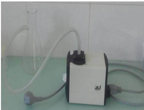
Figure II-5. Equipement de filtration sous vide.
