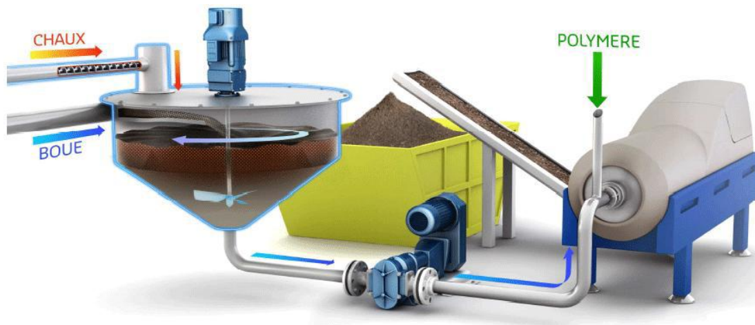
Figure 15- Schéma d'un fonctionnement de stabilisation chimique [17]
