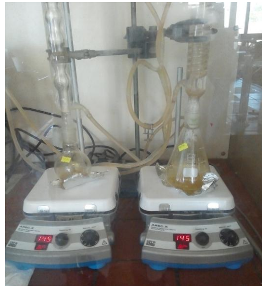
Figure II-12. Chauffage associé à un dispositif à reflux pour la récupération des vapeurs.
