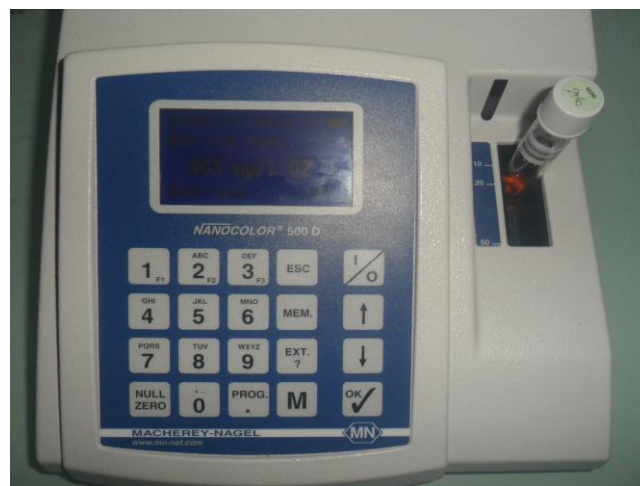
Figure II-3. Photomètre de photomètre de type NANOCOLOR® et PF-10
