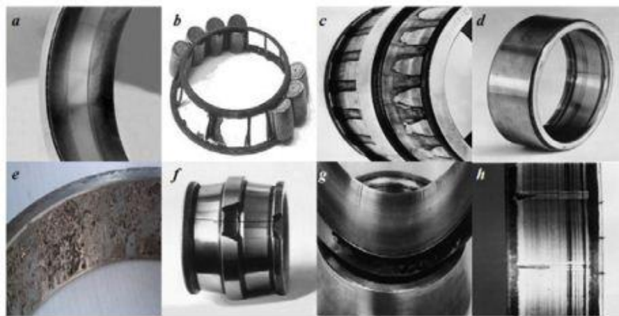
Figure I.12 :Quelques défaillances affectant les roulements.
