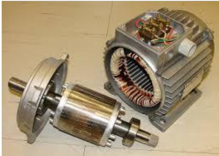
Figure I.18 : Un rotor et un stator.
