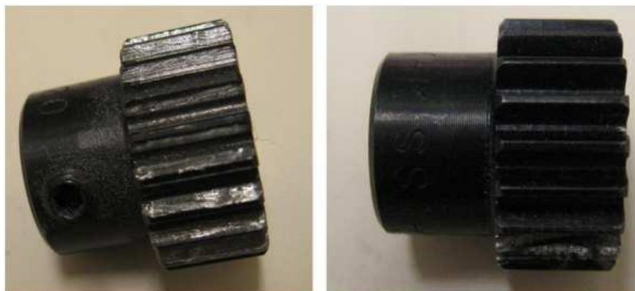
Figure I.6 : Un défaut d'engrenage (à gauche : l'usure de toutes les dents ; à droite : fragment d'une dent).
