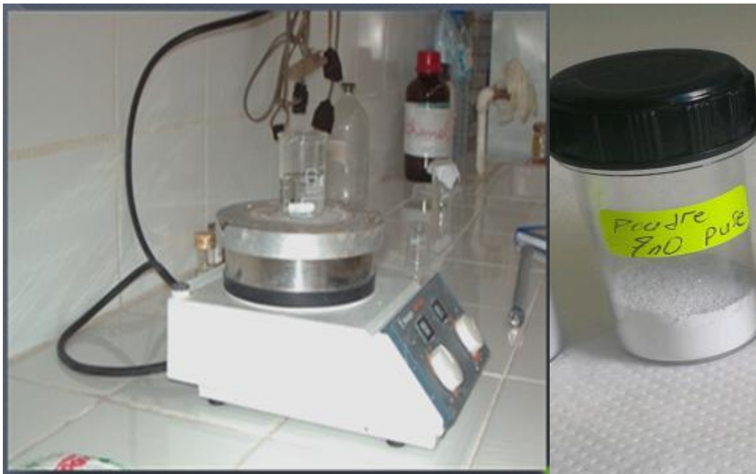
Figure III.5.a : Solution de ZnO pure sous agitation magnétique Figure III.5.b : Poudre de ZnO.
