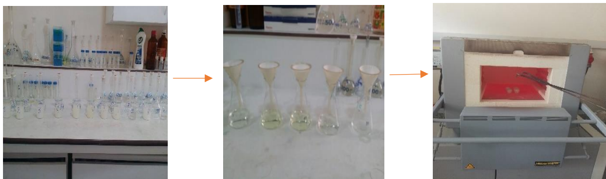
Figure II.3 : Les étapes de détermination \text{SO}_3 [photos prise au niveau de laboratoire chimie de l'ORGM]
