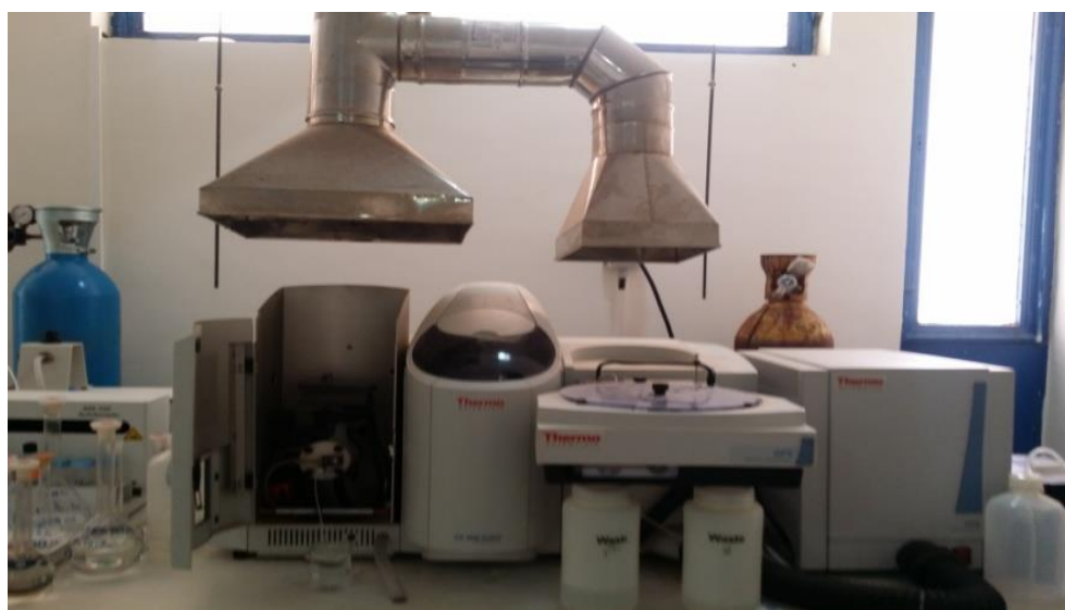
Figure II.4 : Spectromètre d'absorption atomique AA240-type VARIAN [photos prise au niveau de laboratoire chimie de l'ORGM]
