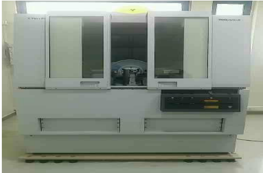
Figure II.10 : Appareillage de diffraction des rayons X type Panalytical [la photo est prise au niveau de laboratoire minéralogique de l'ORGM]
