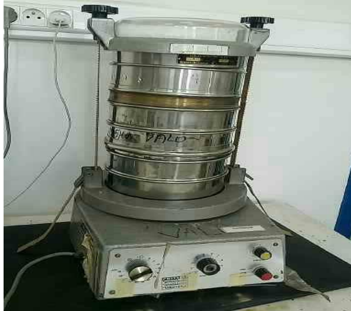
Figure II.11 : Tamiseuse en électro-vibrante [la photo est prise au niveau de laboratoire de valorisation de l'ORGM]
