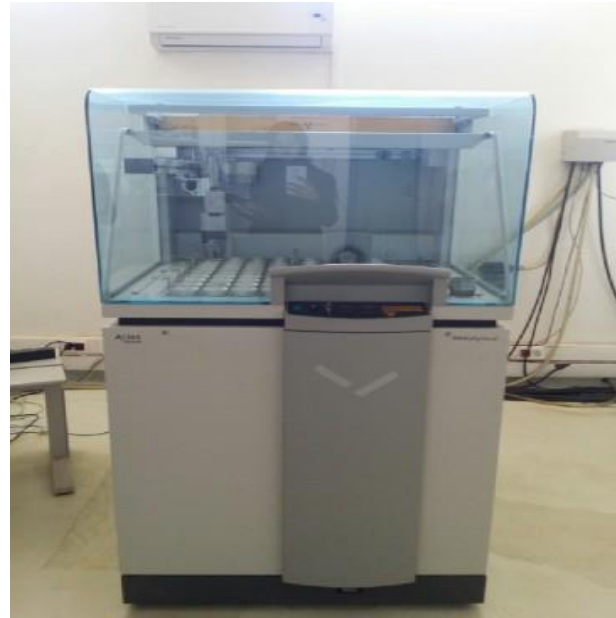
Figure II.6 : Spéctromètre AXIOPANalytical [photo prise au niveau de laboratoire chimie de l'ORGM]
