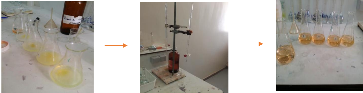
Figure II.2 : les étapes de détermination le CaO [photos prise au niveau de laboratoire chimie de l'ORGM]
