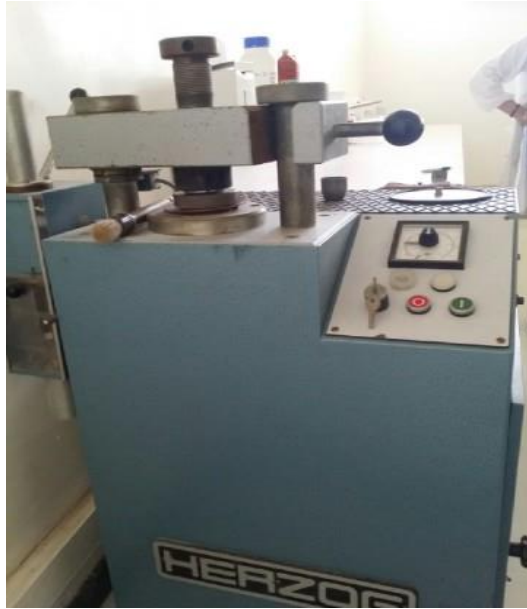
Figure II.5 : La presse de pastille [photo prise au niveau de laboratoire chimie de l'ORGM]
