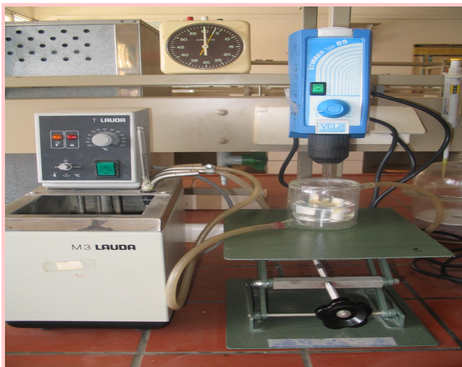
Figure IV- 3 : Schéma du dispositif utilisé pour les opérations d'adsorption.
