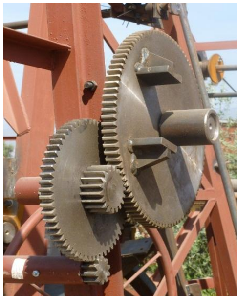
Figure I.12. Engrenages du système de basculement de la cuve.
