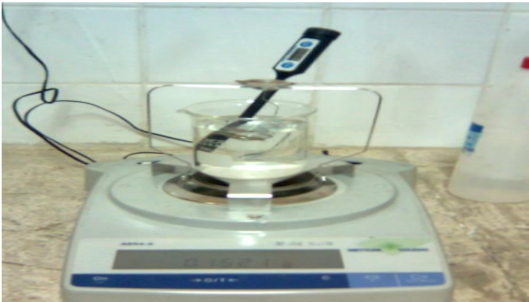
FIGURE 4.9 – Photographie du densimètre.
