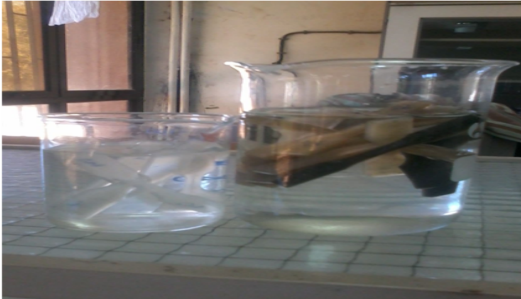
FIGURE 4.11 – photographie du montage du test d'absorption d'eau.
