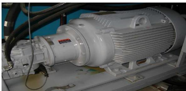
**Fig.III.6** : Système de démarrage hydraulique.
