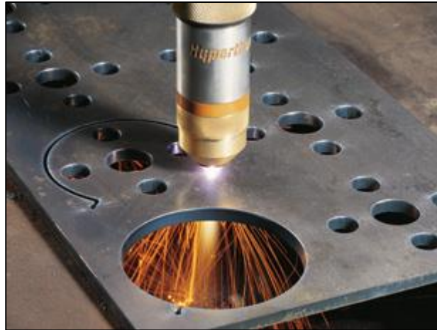
Figure II.13 : Coupage au plasma.
