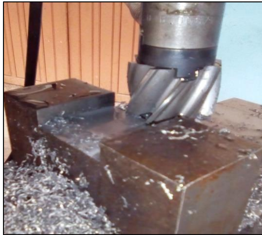
Figure IV.8 : Usinage de la rainure de la deuxième plaque avec une fraise 2 tailles à alésage et à entraînement par tenon diamètre 50mm.
