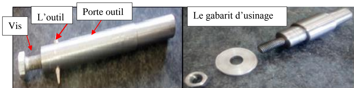
Figure IV.13: L'outil, porte outil et le gabarit d'usinage.
