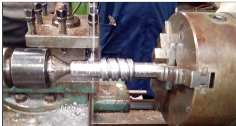
Figure IV.17 : Usinage de deuxième filet.
