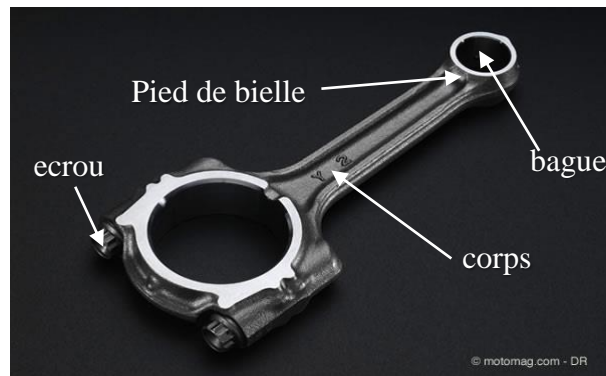
Figure I.9 : Les composants d'une bielle.
