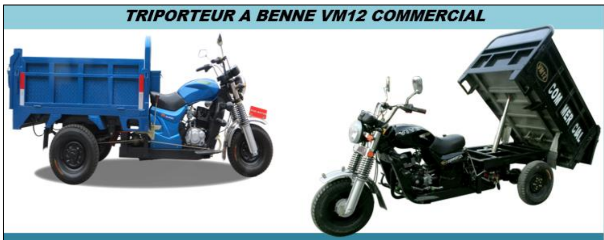
Figure III.8 : Triporteur a benne VM12 commercial de VMS industrie avec un moteur monocylindre ,4 temps.
