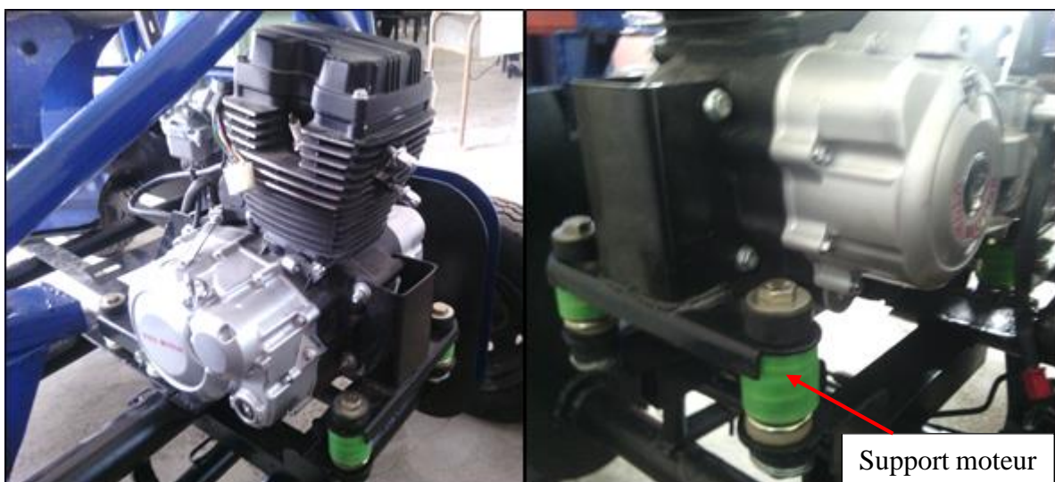
Figure IV.11 : Positionnement et fixation du moteur sur le châssis de la machine.
