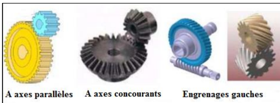
Figure III.3 : Les différents types d'engrenages.
