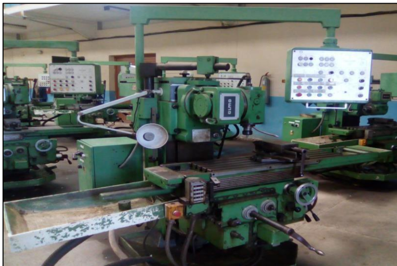
Figure IV. 4 : La fraiseuse conventionnelle FH 1.6 utilisée pour le taillage des dentures de la roue en bronze.
