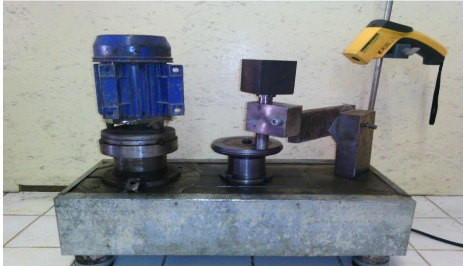
Figure II-7. Dispositif d'essai d'usure avec la configuration pion stationnaire-disque rotatif.
