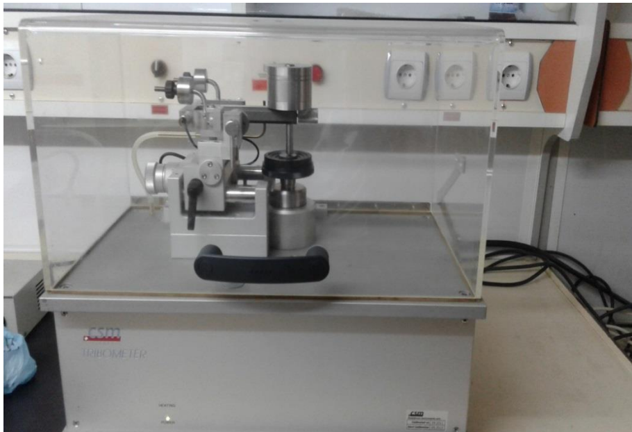
Figure II-10. Illustration du dispositif disque rotatif pion stationnaire type CSM.
