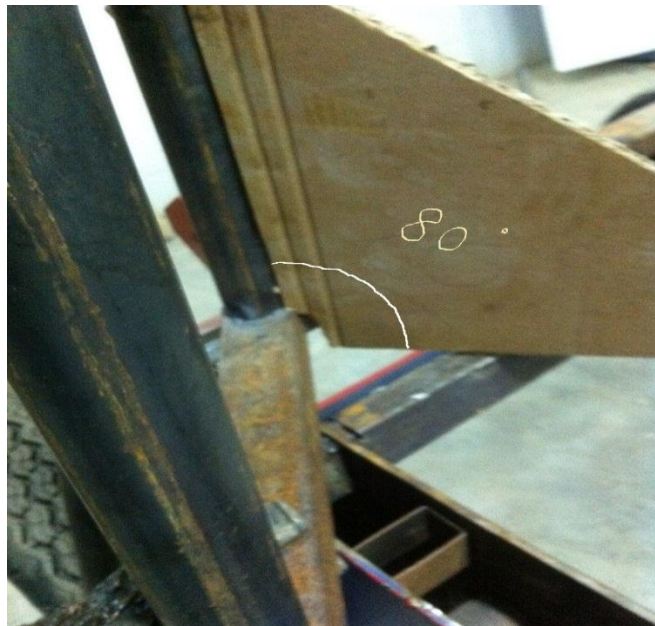
Fig. 58: Gabarit d'orientation des montants à 80^\circ .
