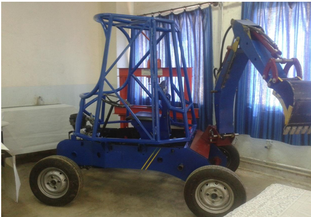
Fig.61 : La cabine finalisée et fixée sur le châssis.
