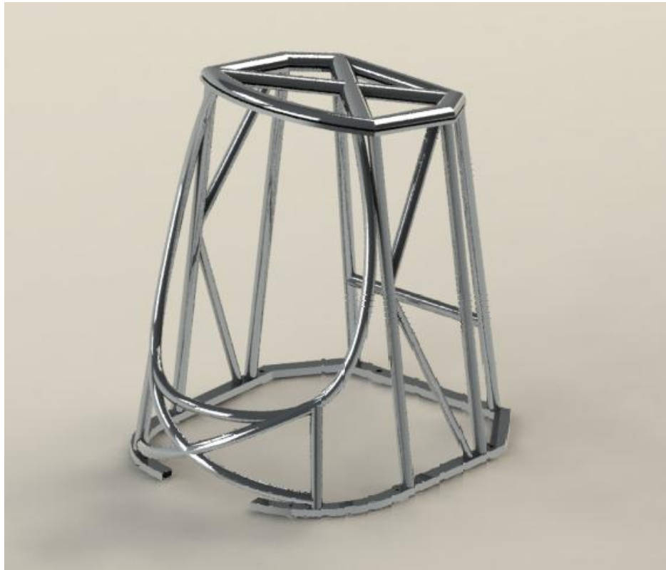
Fig51. Rendu final 3D de la cabine sue le logiciel de simulation Solidworks.
