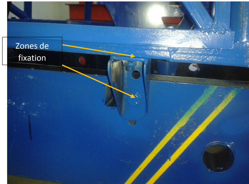
Fig36. Fixation de la cabine sur le châssis, appelé géométrie fixe sur le logiciel
