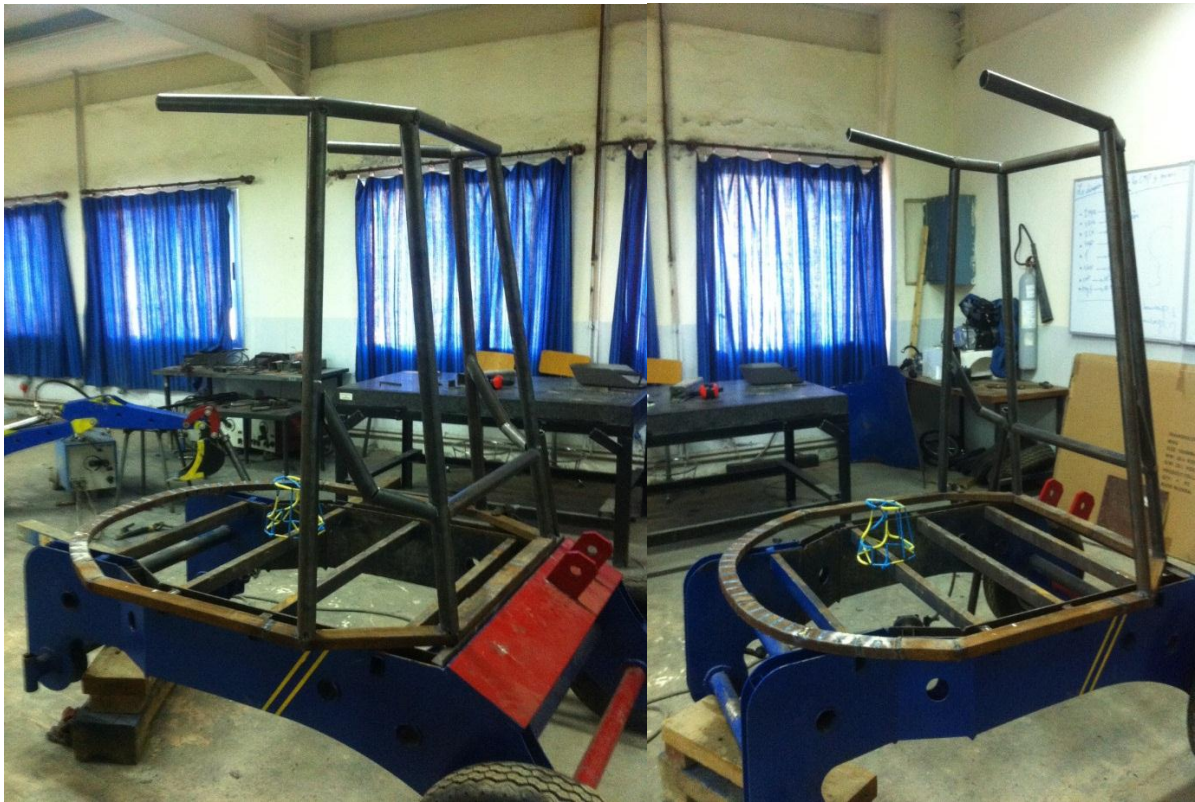
Fig.59 : Montants soudés , debut de réalisation .
