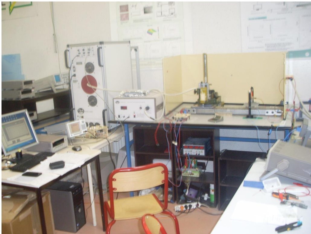
Figure IV.1 : photographie générale du dispositif expérimental de dépôt de charge, de mesure et d'acquisition de données.
