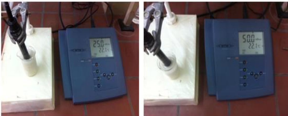
Fig. IV. 3: Appareil de mesure de la conductivité volumique des solutions polluantes (Conductimètre)
