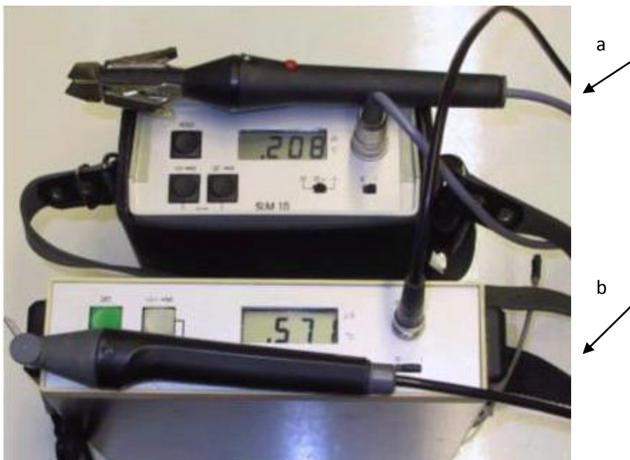
Fig. III. 2: Dispositif allemand de surveillance de la sévérité de pollution SLM 10 (a: Sonde à électrodes planes, b: Sonde à électrodes linéaires)
