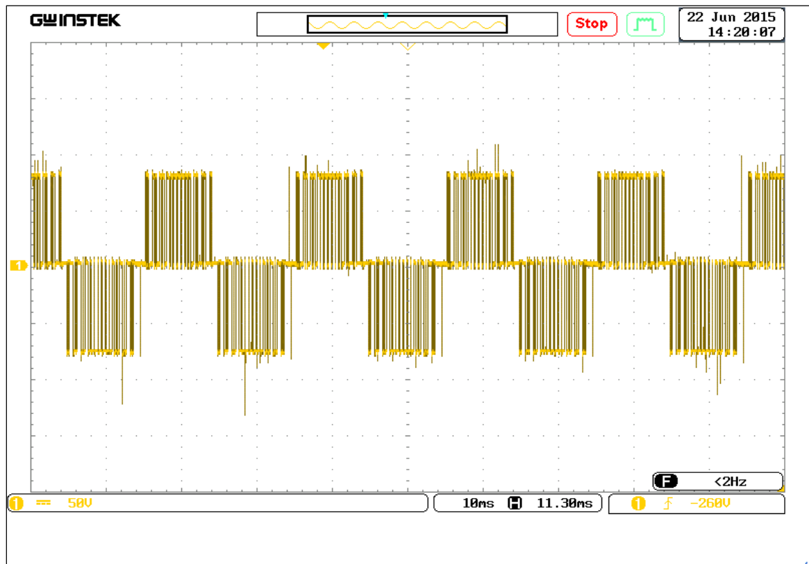
Figure III.28. Tension composée U_{ab} à la sortie de l'onduleur (commande MLI).
