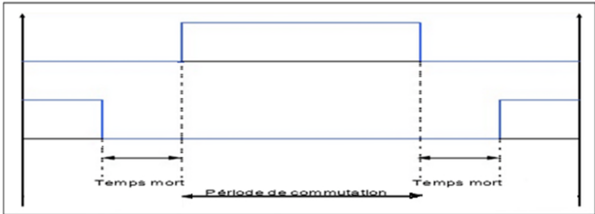
Figure II.19. Exemple de période de commutation avec temps mort
