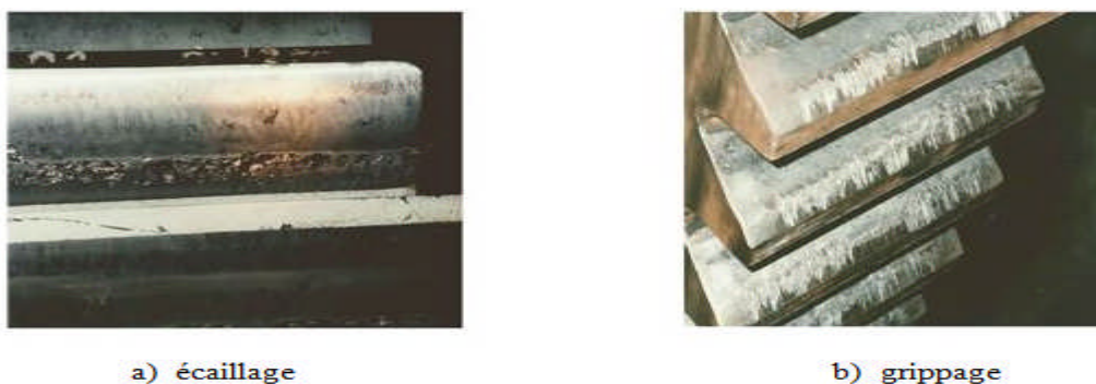
Figure IV.12. Défauts d'écaillage, grippage.
