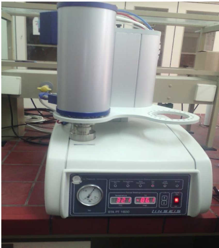
Figure 10 : L'appareil STA PT 1600 de type LINSEIS utilisé pour l'analyse DSC.
