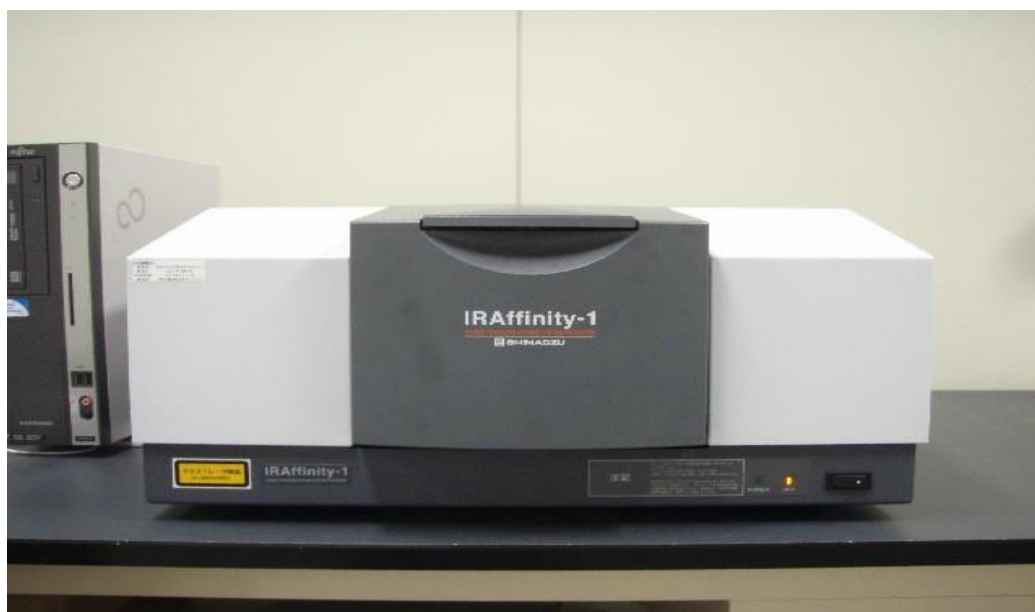
Figure 09 : L'appareil IRAffinity-1 utilisé pour l'analyse IRTF.
