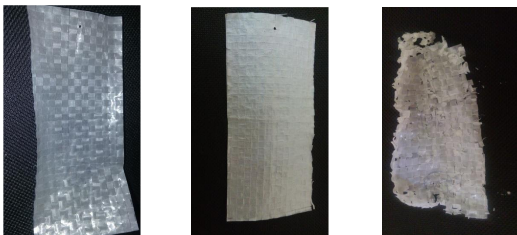
Film à 0% du pro-oxydant. Film à 0.5% du pro-oxydant. Film à 1% du pro-oxydant.
