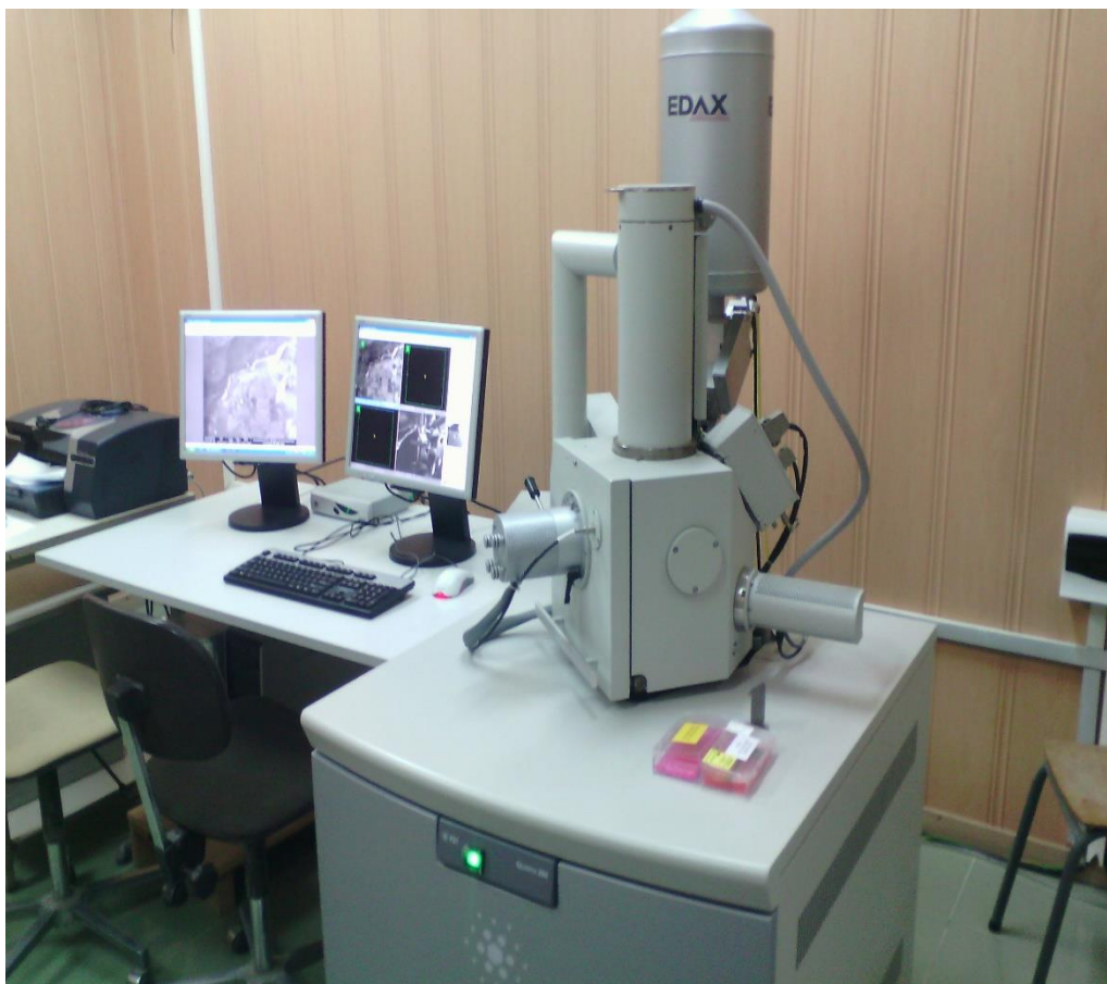
Figure 13 : Le microscope utilisé pour visualiser la morphologie de nos échantillons, de type FEI Quanta 200 qui a un détecteur GSED.
