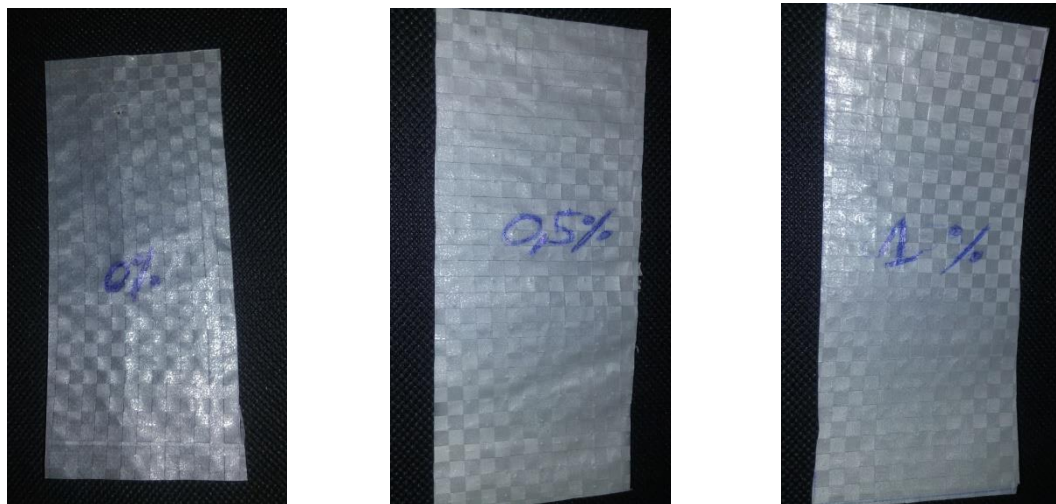
Film à 0% du pro-oxydant. Film à 0.5% du pro-oxydant. Films à 1% du pro-oxydant.
