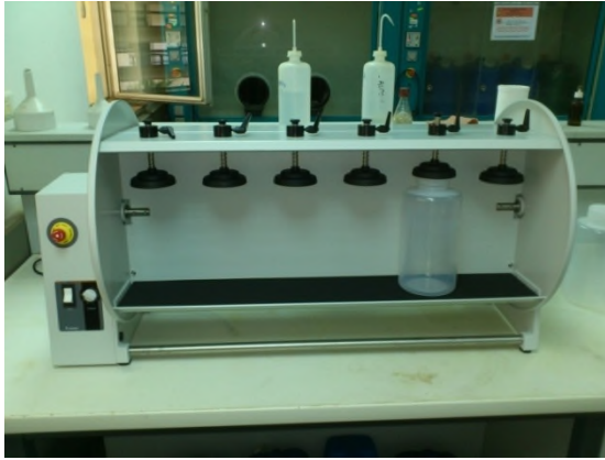
1- Dispositif d'agitation pour l'essai de lixiviation
