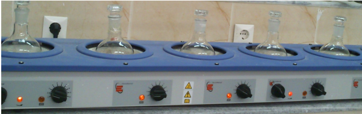
Figure I.1 : Schéma du dispositif expérimental utilisé pour les essais d'adsorption.
