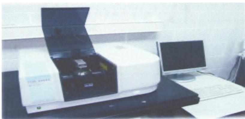
*Figure IV.5. Spectromètre de FT-IR utilisé*
