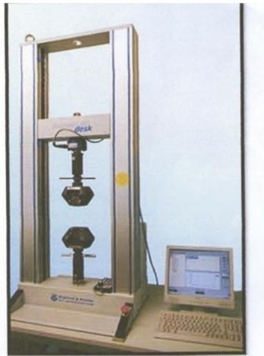
Figure III.8: Machine d'essai de traction.
