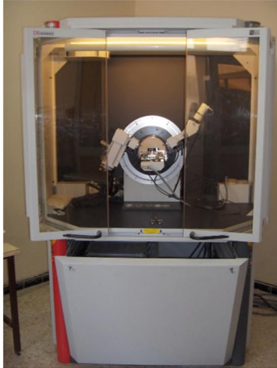
Figure IV.2. Diffractomètre des rayons X utilisé
