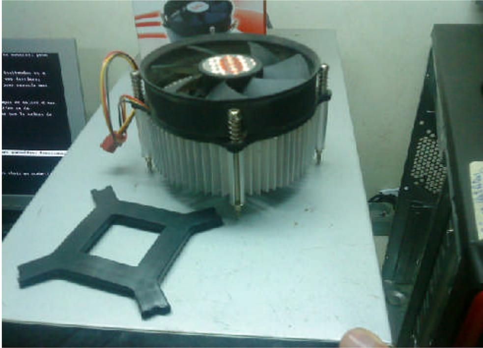
Figure 56. Ventilateur qui a cessé de fonctionner à cause d'une surchauffe (Stage).
