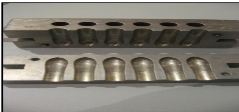
Figure III.2. Moule à suppositoire par compression.
