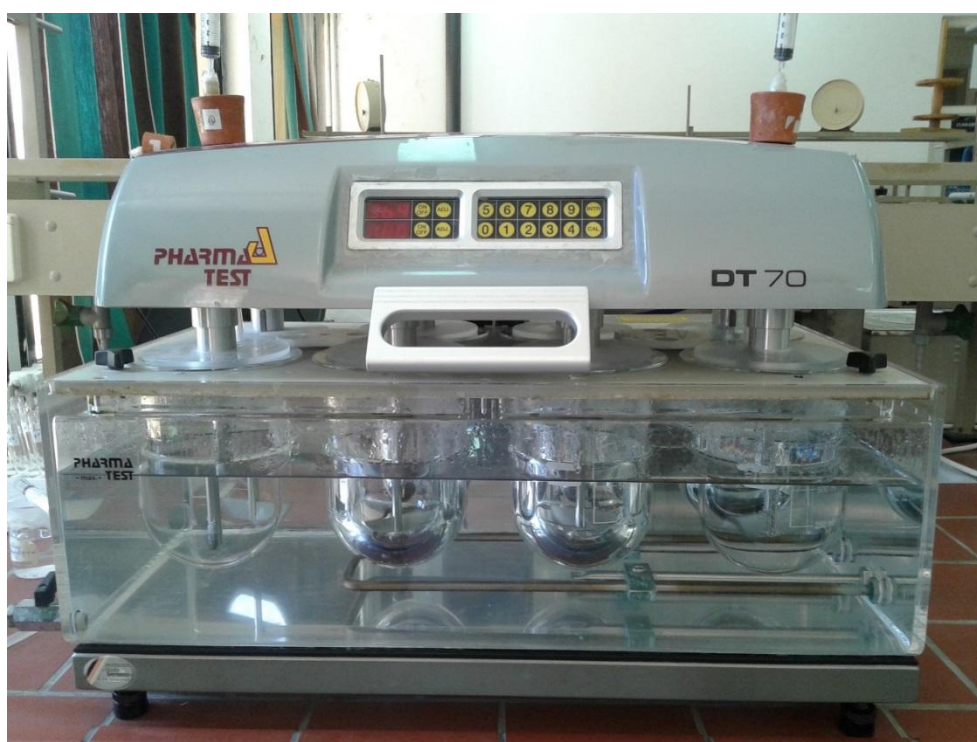
Figure III.3 : Installation du dissolutest mise en œuvre pour l'étude de la cinétique de libération.
