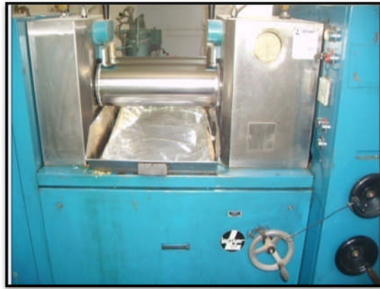
Fig.10 : Vue d'ensemble de la calandre utilisée lors de la préparation des composites.
