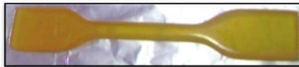
Fig.15: Echantillon sous forme d'haltère.
