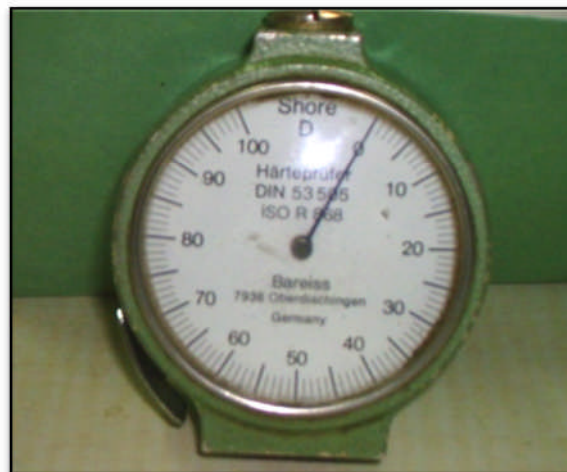
Fig.16 : Duromètre shore D.
