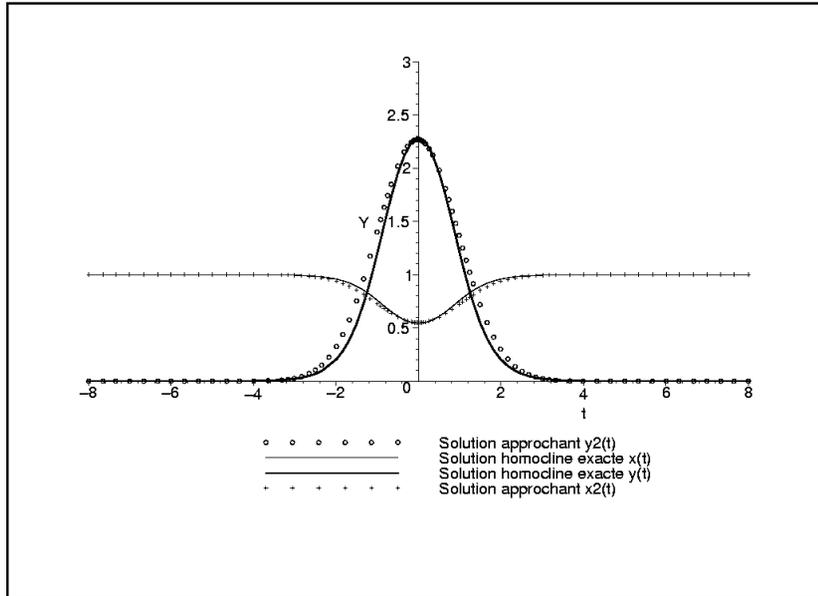
**Figure 1.** La solution homocline exacte et approchée de (4.17) quand  $N = 2$ .
