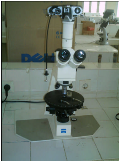
Figure (III-14) : vérification de l'épaisseur de l'échantillon avec un microscope
