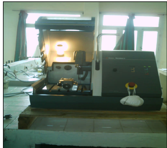
Figure (III-9) : Scie diamantée Laboratoire- LTMGP- U- Bejaia
