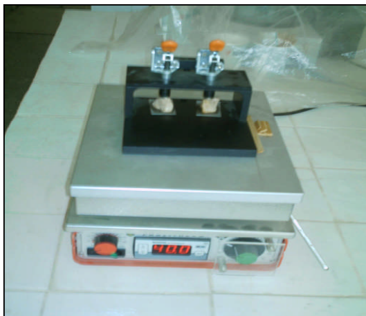
Figure (III-10) : Collage de l'échantillon sur la lame de verre. Laboratoire LTMGP Université - Bejaia
