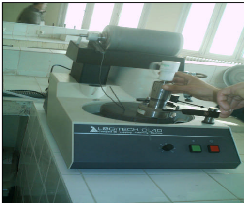
Figure (III-12) polissage dégrossi LTMGP Université - Bejaia
