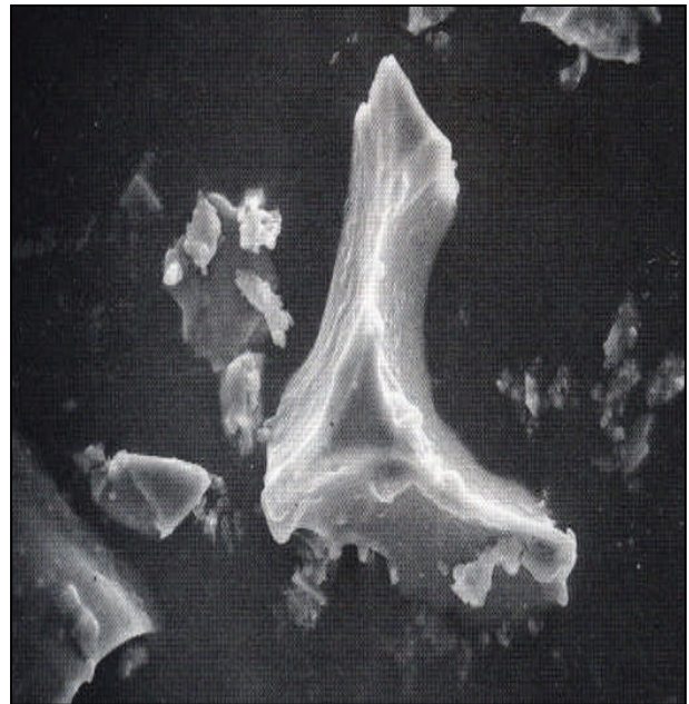
Figure (I-4) : fines anguleuse : leur usage conduit à dosage supérieur d'eau. [14]
