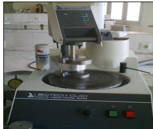
Figure (III.13) polissage de finition LTMGP Université - Bejaia
