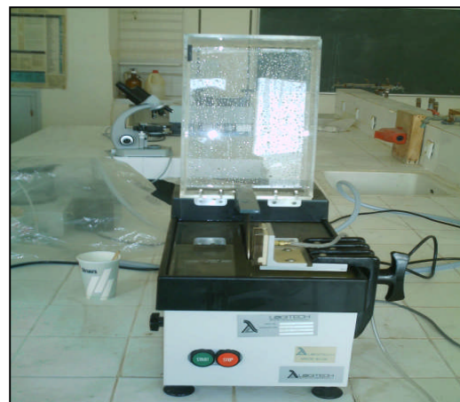
Figure (III-11) : scie d'arasement. Laboratoire- LTMGP- U- Bejaia
