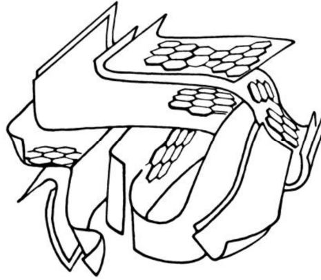
Fig.I.8. Représentation de la microstructure d'un charbon actif [44].
