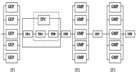
Fig1. Diagramme de fiabilité de l'oléoduc
