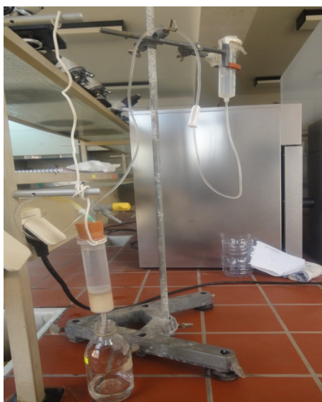
Figure. 3 : Montage de la chromatographie en phase inverse effectuée sur gel de C 18 .
