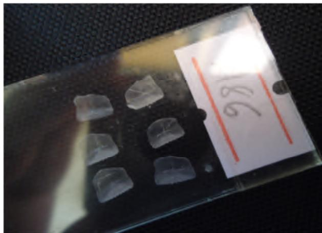
**Figure 13** : Méthode de préparation de montage des écailles de *B. boops* L. pour la lecture de l'âge.
