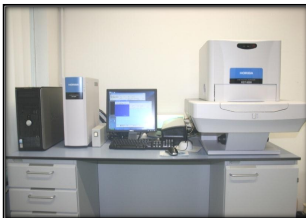
Figure 9 : Photo de l'appareil micro Fluorescence des Rayons X HORIBA XGT 5000 prise à l'INCC.
