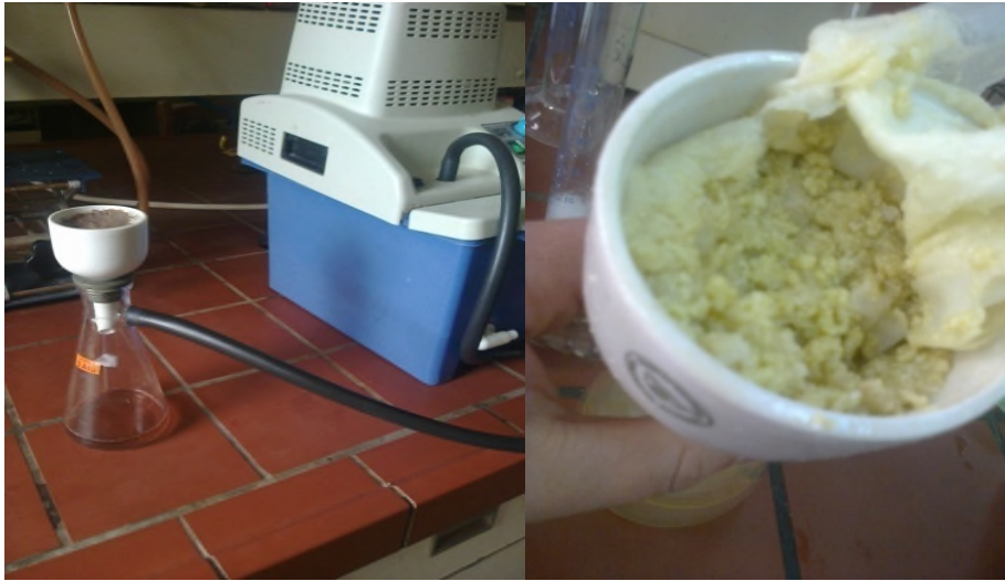
Figure 21 : Filtration du savon
