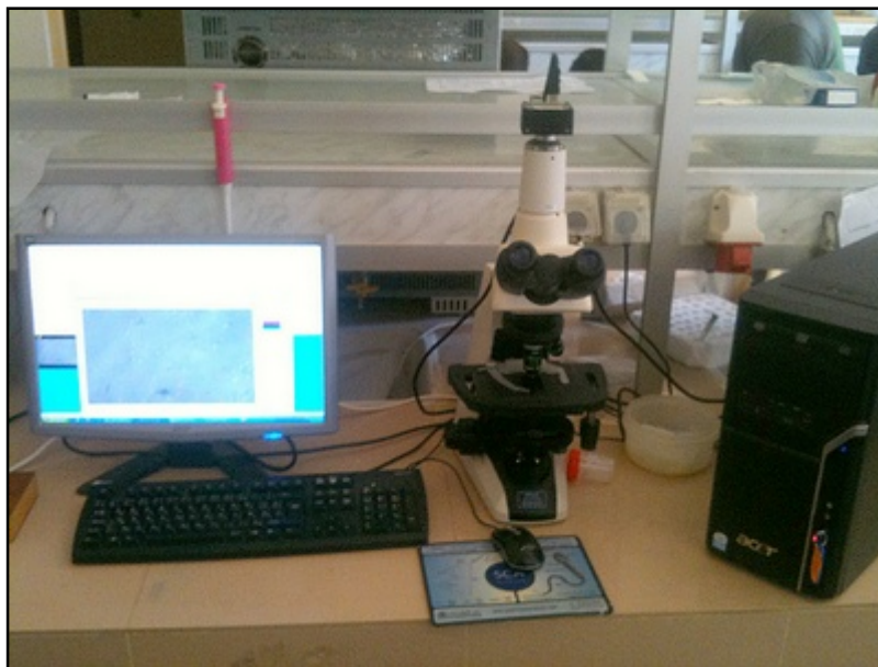
Figure 18 : Analyseur informatique de marque SCA utilisé pour le calcul des vitesses de progressions des spermatozoïdes.
