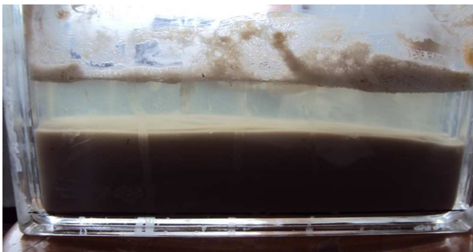
A la fin du traitement d'électroflottation
