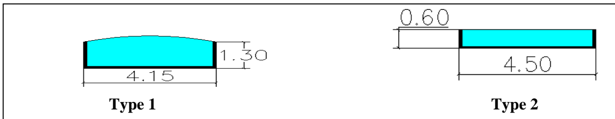
Figure II.6 Dalle sur 3 appuis.
