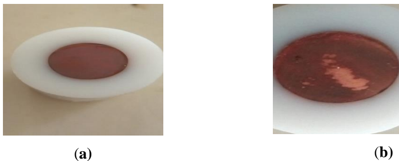
Figure III.13 : Etat de surface d'une l'électrode de cuivre après 24 heures d'immersion dans une solution [HCl]=35mM a) 0tr/mn, b) 1000tr/mn
