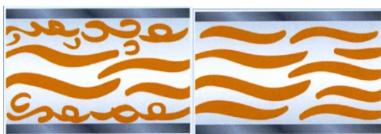
Figure I.11 : Alignement de micelles cylindriques sous l'effet de l'écoulement
