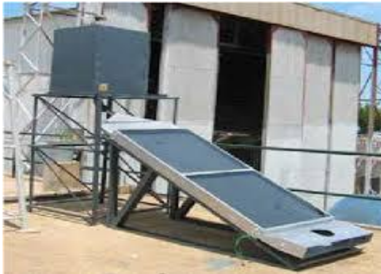
Figure 11: Séchoir solaire indirect destiné au séchage des PAM, réalisé au CDER ( Boulemtafes and Benaouda 2006 )
