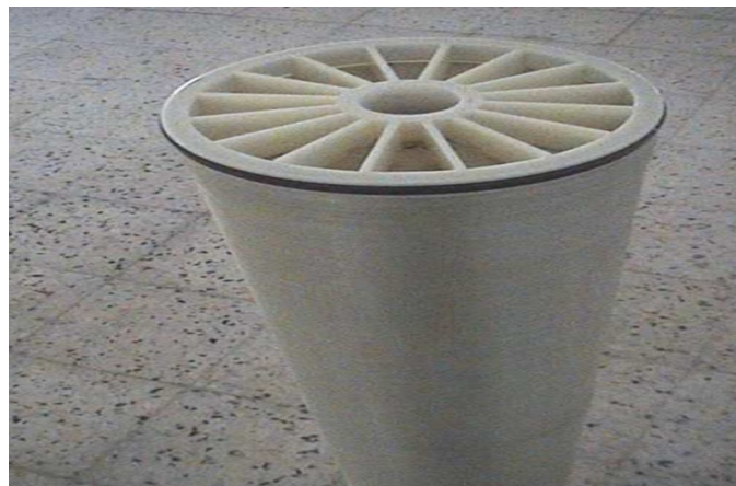
Figures N°7 : La face externe d'un module d'osmose inverse utilisée au niveau de Cevital (Zatouche, Bouakkaz, 2012).
