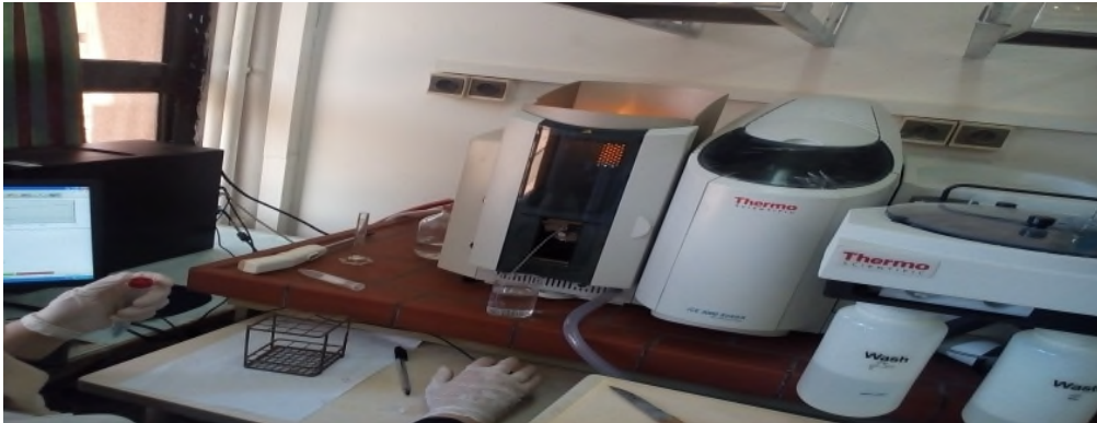
Figure 15 : La spectrométrie d'absorption atomique à flamme.
