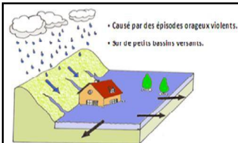
Figure 26 : crue par ruissellement urbain.
