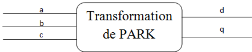
Figure II.6 : passage du triphasé vers le biphasé
