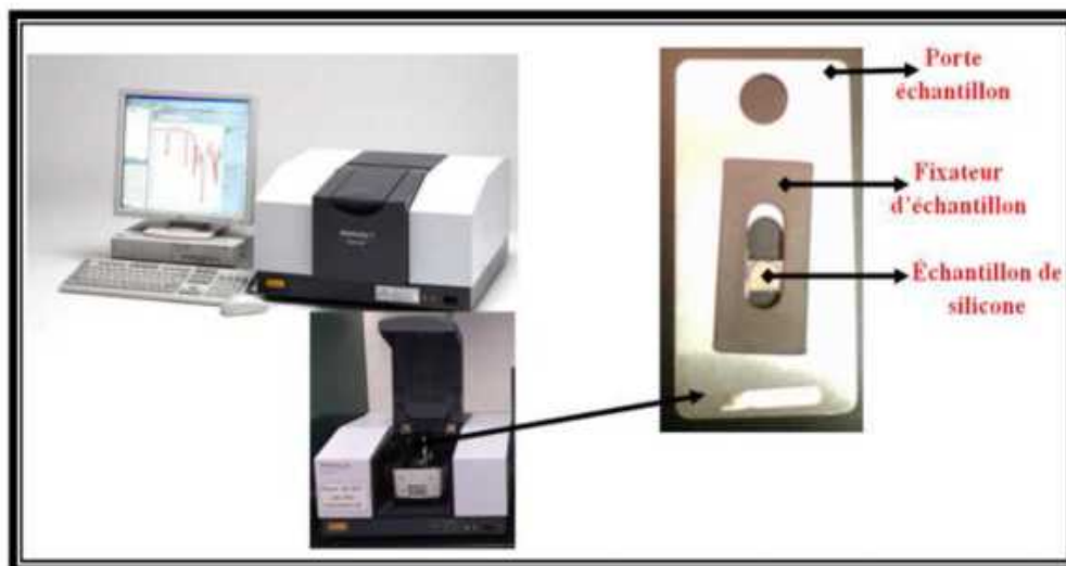
Fig II. 11: Photo du spectrophotomètre IR affinity-1 et le mode de pose de la pastille.
