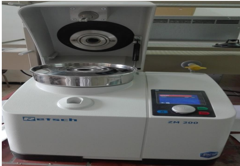
Figure III.1. : Broyeur universel de laboratoire pour matière plastique et bois.
