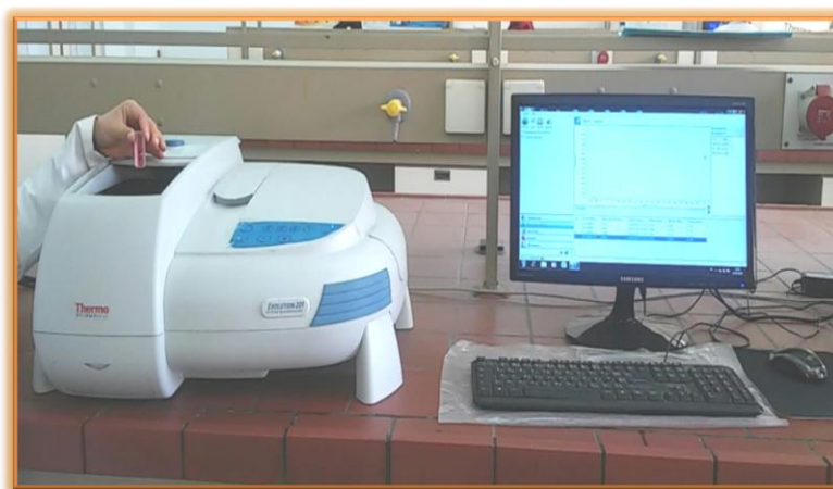
Figure IV-6 : Spectrophotomètre d'absorption UV-Visible (EVOLUTION 201).
