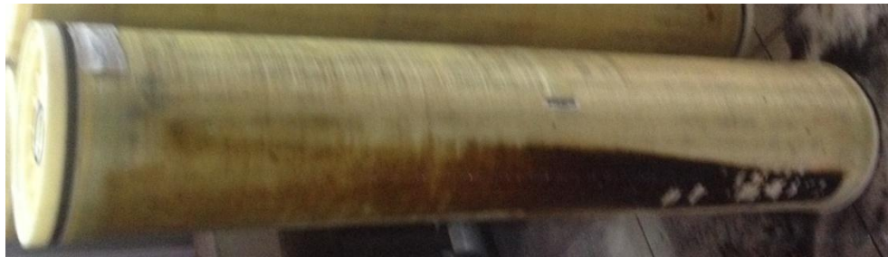
Figure II.6 : Photographie d'un module spirale utilisé à CEVITAL.
