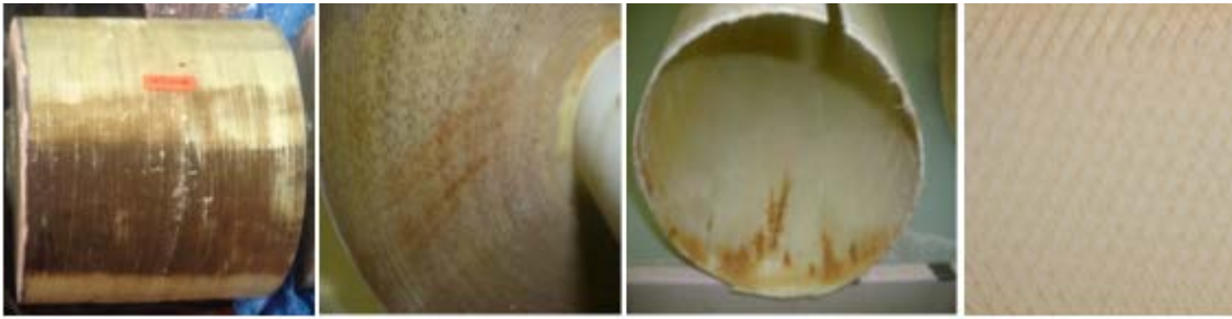
Figure III.1 : Photographie d'observation visuelle interne des membranes usées.
