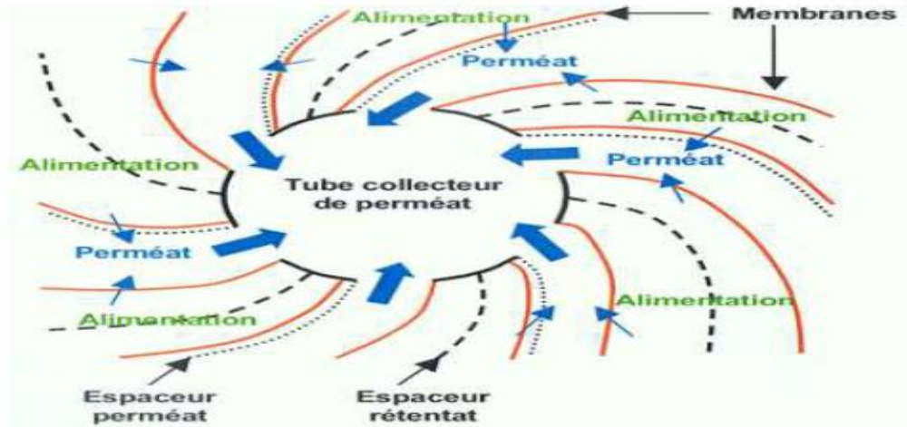
Figure I.10 : Principe de fonctionnement d'une membrane spirale vue en coupe [17] .
