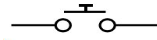
Figure II.10 : Schéma d'un BP (NO) [6]
