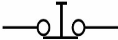
Figure II.11 : Schéma d'un BP (NF) [6]
