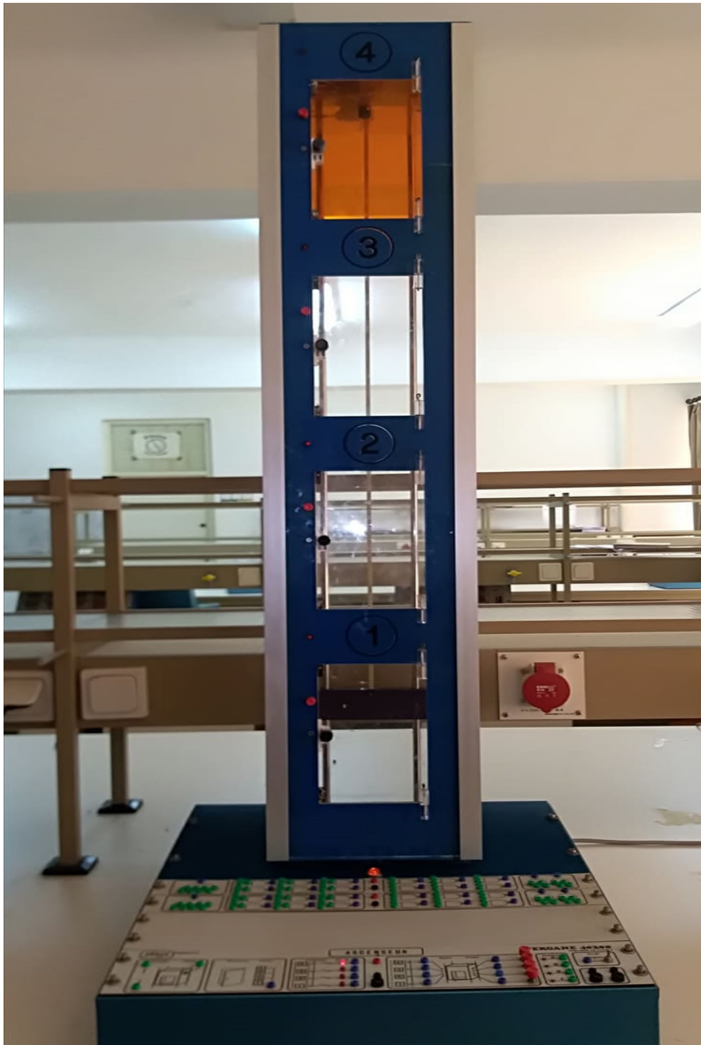
Figure III.2 : La maquette de l'ascenseur
