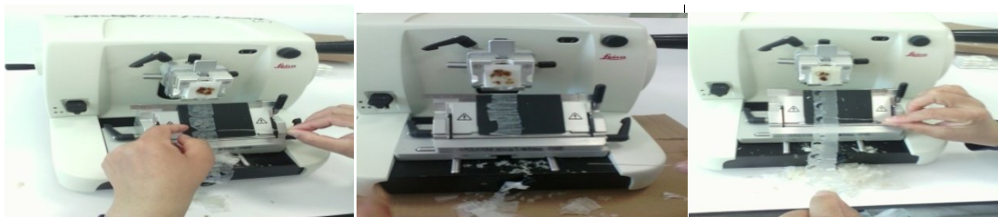
Figure N°18 : Etapes de la réalisation des coupes avec un microtome.
